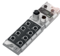
用于收集信号并通过网络传递到PLC的现场总线模块
