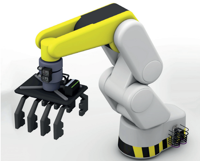
抓手和机械臂之间的非接触式信号传输
