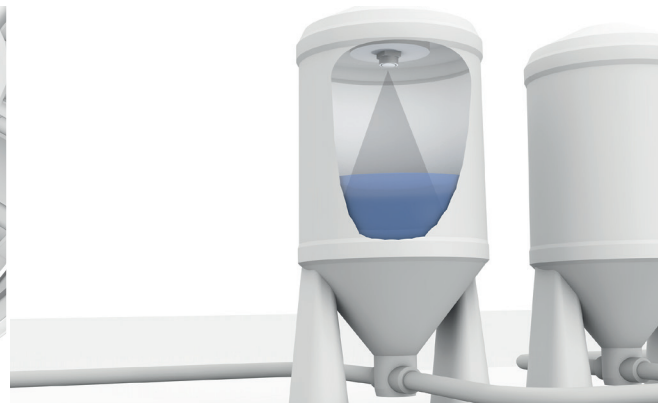
超声波传感器检查油箱的液位高度。
