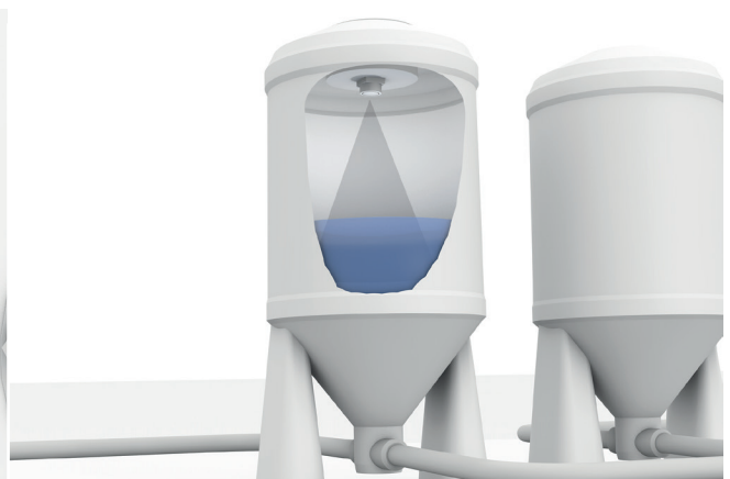
Füllstandsmessung von Flüssigkeiten in einem Tank mit Ultraschall-Sensoren
