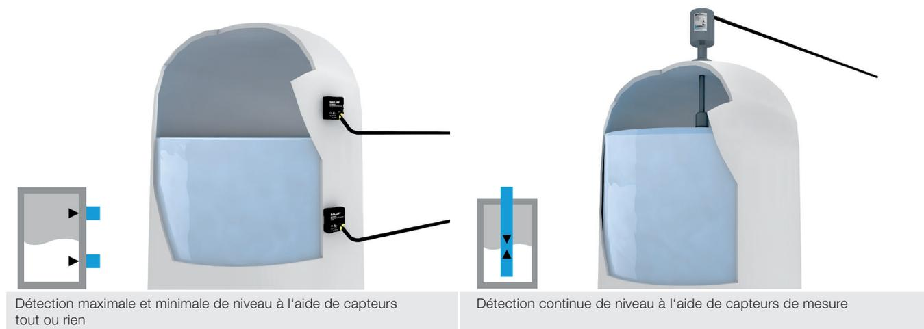
Dans certaines applications, la détection de deux positions est suffisante : le point initial et le point final. Dans d'autres applications, la détection de position est importante sur la totalité du tronçon de mesure. Selon les informations dont vous avez besoin, vous choisirez des capteurs tout ou rien ou des capteurs de mesure. Lors de la sélection, il convient de tenir compte des critères suivants :
