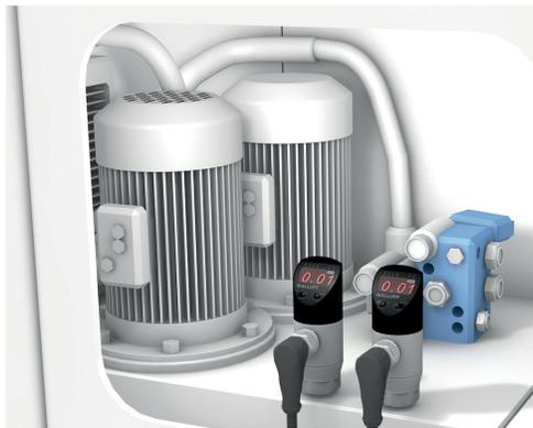
Surveillance de réfrigérant lubrifiant sur les machines-outils au moyen de capteurs de pression
