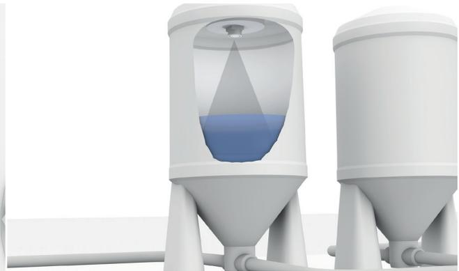
Mesure de niveau de liquides dans un réservoir au moyen de capteurs à ultrasons
