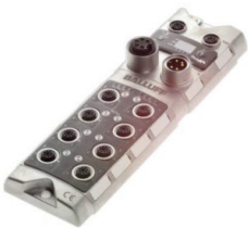
Modulo bus di campo Ethercat in metallo per l'impiego decentrato (8 slot)
