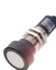
Czujnik ultradźwiękowy do pomiaru odległości do wszystkich materiałów do kilku metrów
