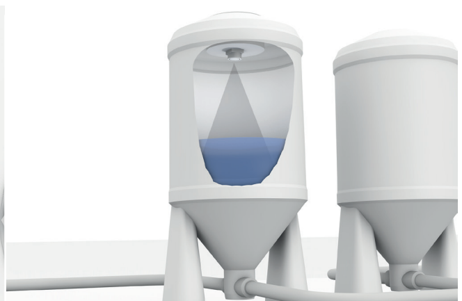
Pomiar poziomu cieczy w zbiorniku za pomocą czujnika ultradźwiękowego
