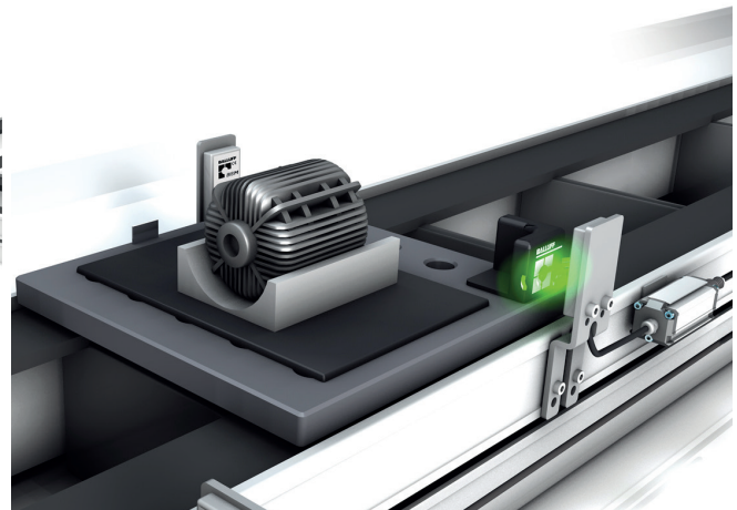
Leitura da tag via cabeça de leitura/escrita RFID com unidade controladora separada em caso de espaços limitados
